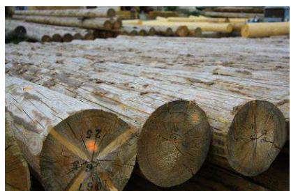
Prvou z možností je výstavba z materiálu, ktorý bol pred tým odkôrnený a uložený na niekoľko mesiacov na skládke, aby sa dosiahlo zníženie jeho vlhkosti. Následne je materiál hobľovaný ručnými elektrickými hoblíkmi. Z takto pripraveného materiálu sa ďalej pokračuje vo výstavbe. Po jej dokončení, sa na vonkajšie plochy ihneď aplikuje povrchová úprava.
